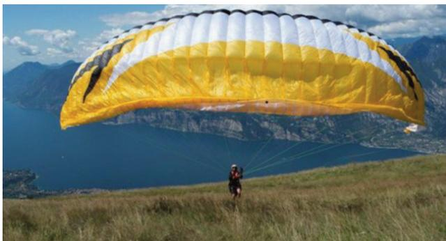
Decollo con il RAST: si nota in modo assai chiaro che la vela, essendo ancora "sgonfia" nella zona CORE (posteriore) oppone pochissima resistenza al trascinamento del vento. Inoltre, occorre esercitare meno forza per il gonfiaggio, che risulta dunque meno dinamico e più progressivo
