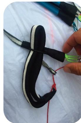
Le bretelle del K-Light sono realizzate con grandissima cura del dettaglio. Destra e sinistra hanno occhielli di differente colore. Per fermare il freno è ottima la soluzione adottata di realizzare un semplice "loop" in materiale elastico; a nostro avviso meglio dei magneti e dei bottoni a pressione.
