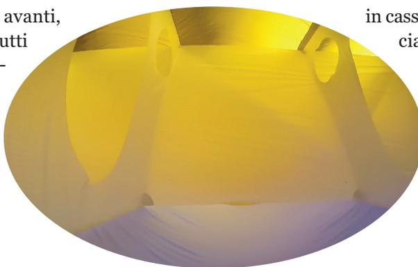
Foto del RAST 1.0 presa in volo all'interno di un cassone: si vede perfettamente la "paratia" che divide la vela per lungo e, sopra ad essa, l'apertura (chiamata valvola) che favorisce il passaggio dell'aria all'interno della parte posteriore della vela
