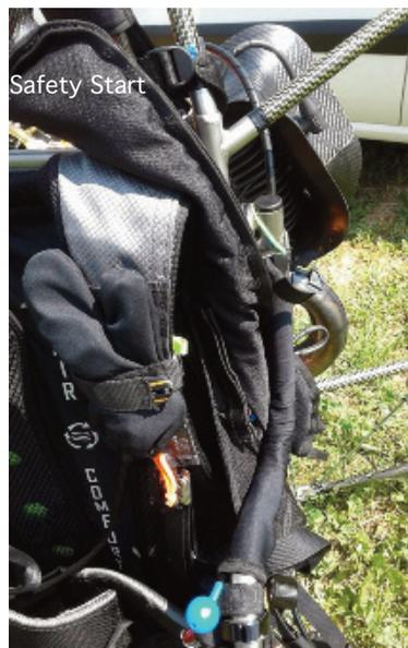
carbonio), esteticamente bellissimo, leggerissimo e non invasivo, dopo aver indossato il paramotore sarà possibile, con l'apposita "pallina", agire direttamente sulla membrana e così ottenere l'innesco della benzina, per un avviamento semplice e sicuro, anche da freddo e/o dopo mesi di inutilizzo. A
